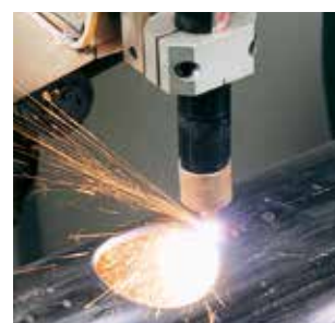
▲直角交差穴切断
