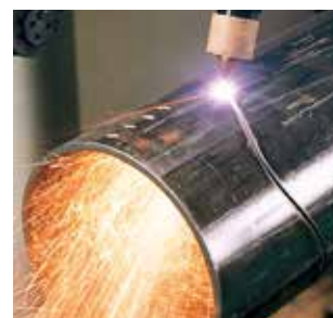
▲斜め交差枝管切断
