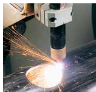
▲直角交差穴切断
