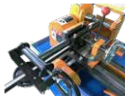
アタッチメントにパイプを取り付けた状態
