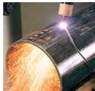
▲斜め交差枝管切断
