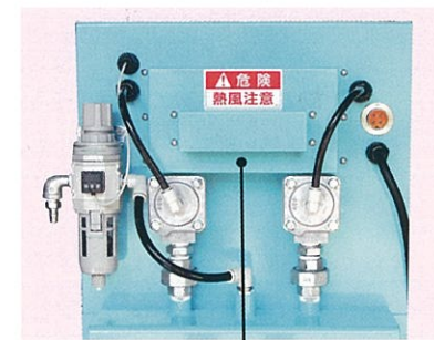
吸音構造の排気口カバー
